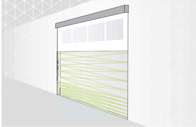
Figure 3: Portes sectionnelles avec effacement des faisceaux
